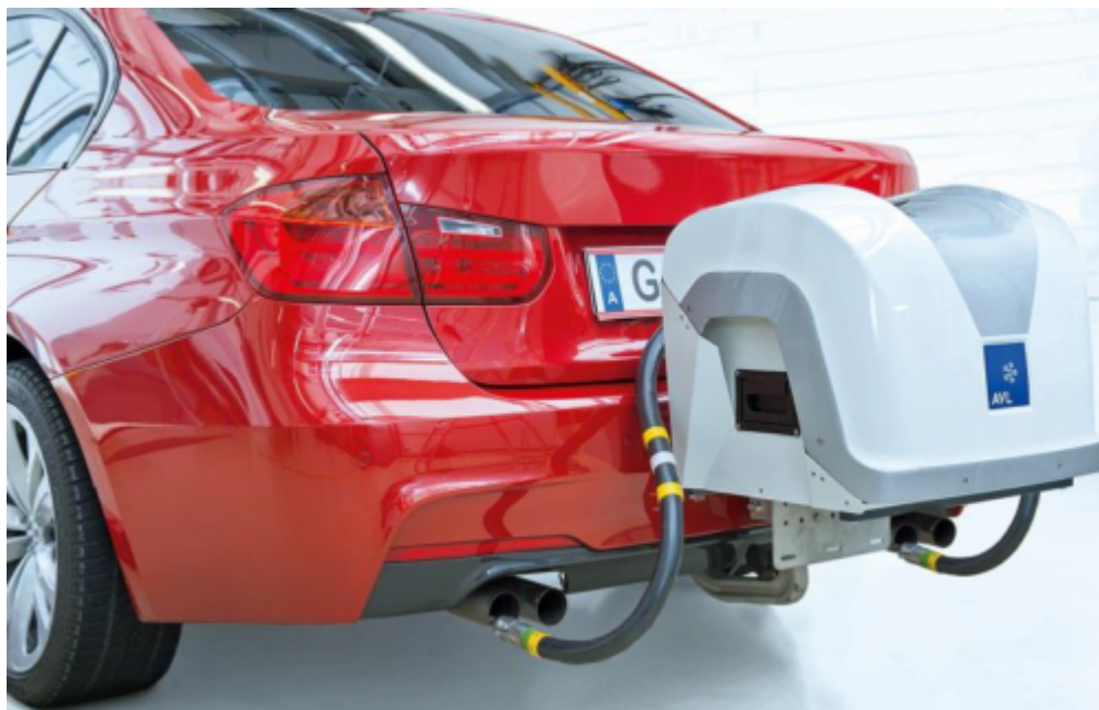
Figur 3: Eksempel på PEMS måleutstyr fra leverandøren AVL. Kilde: AVL
