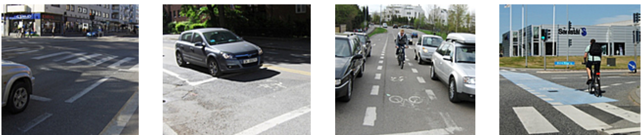
Figur 2. Tilbaketrukket stopplinje for biler på Ring 2 i Oslo, sykkelboks i Middelthunsgate i Oslo, midtstilt sykkelfelt i Monolittveien i Oslo og blått sykkelfelt i kryss i Silkeborg i Danmark. Foto: M. Sørensen.
