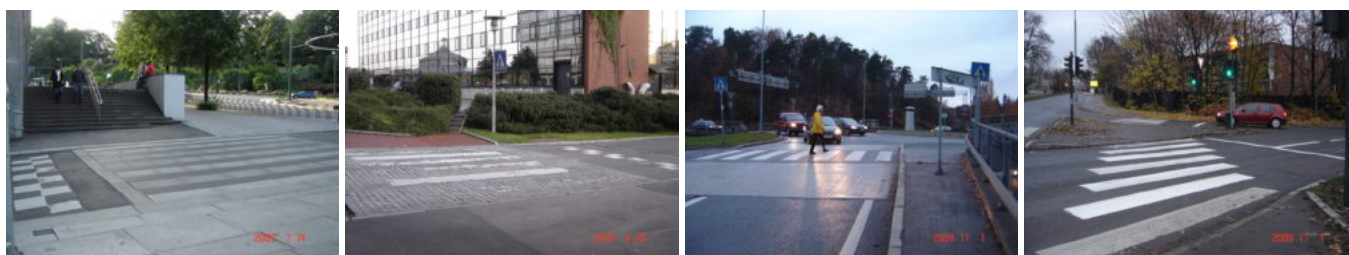
Figur 1: Gangfelt i Oslo med opphøyning, ulike typer belegg samt signalregulering og trafikkøy. Foto: M. Mosslemi.
