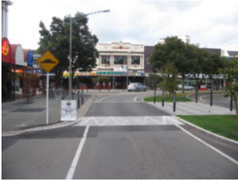
Figur 5: Tilrettelagt kryssingssted med opphøyd kryssingsområde, Palmerstone North, New Zealand (NZ Transport Agency 2009, Foto: G. Connolly).
