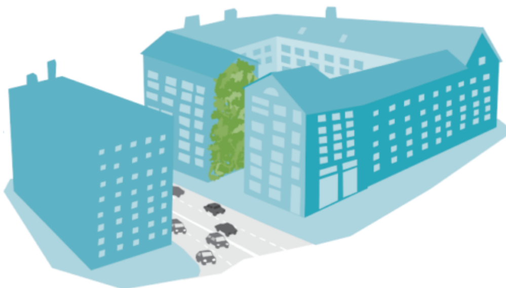
Figur 1: Kledning av spalter i bygningskropp for å redusere lydinnstrømning fra nærliggende gater. Illustrasjon: Tove Hennix.
