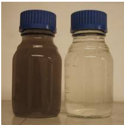
Figur 2: Eksempel på sedimentasjonsbasseng med permanent vannspeil langs veg i et naturområde og et byområde. Foto vannflasker viser innløp av forurenset overvann fra veg til sedimentasjonsbasseng og rensset utløpsvann fra bassenget under et høstregn (Foto: Svein Ole Åstebøl, COWI AS).
