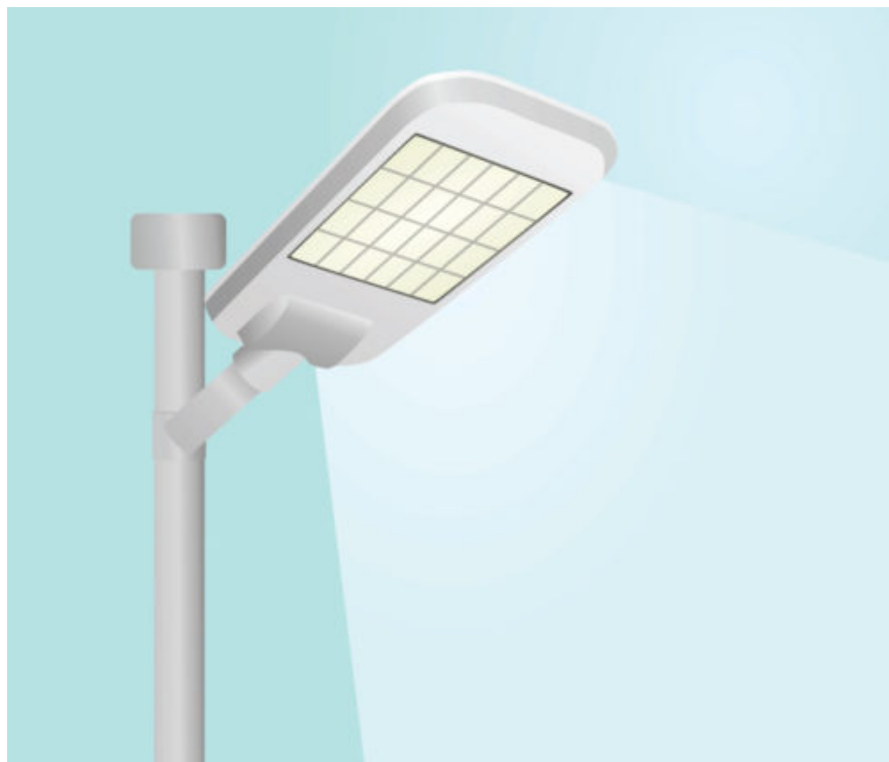
Figur 4: Dette bildet illustrerer hvordan LED-lys med flatt glass gir presise lyskjegler. Man bør være oppmerksom på slike armaturers blendingsforhold. Dioden bør være trukket noe tilbake i armaturhuset. LED-lys er også energieffektive og godt egnede for dimming. Kilde: Shutterstock 718299664.
